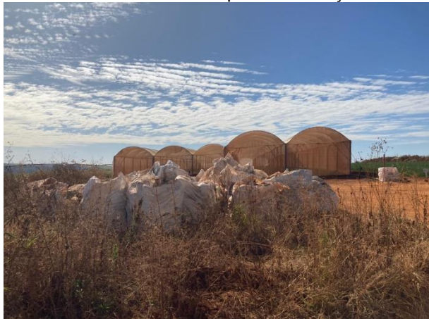
Figura 05: Acondicionamento de bags sem cobertura e sem impermeabilização.
